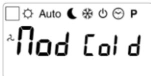
При помощи кнопок (+) или (-) измените режим работы и вернитесь в основное меню при помощи (▶). HOT = ОТОПЛЕНИЕ; COLD = ОХЛАЖДЕНИЕ.
